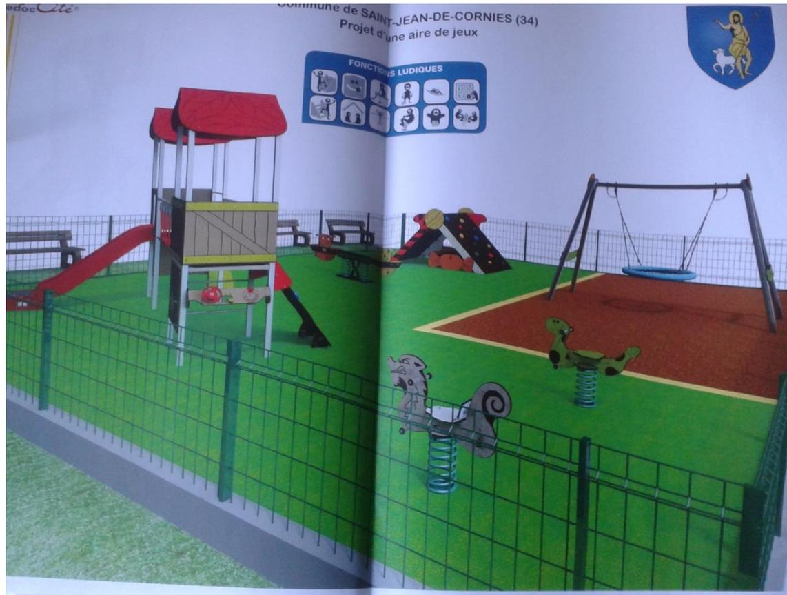
Le sol est souple, composé de plaques de support plastifiées de 2,5 cm d'épaisseur, recouvert de gazon synthétique collé sur le support souple. Le gazon est sablé (23 kg/m<sup>2</sup>) pour garantir son assise, le tout étant conforme aux normes en vigueur.
